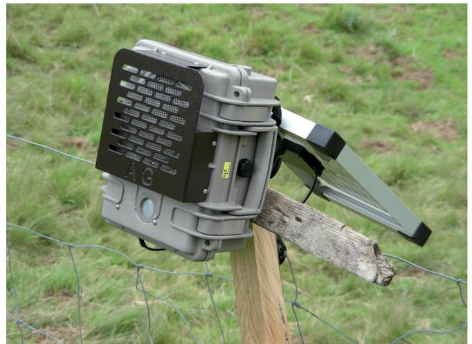
Photo 8 : un « AlarmGuard » muni d'un panneau solaire
