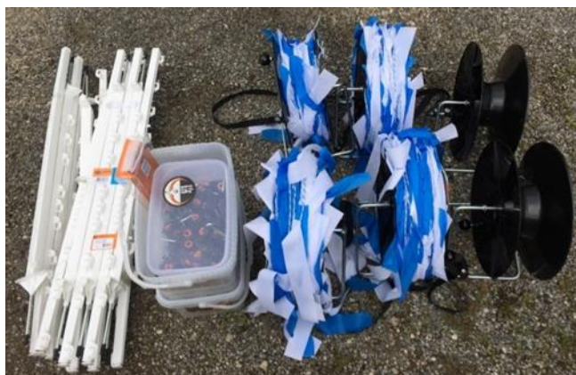
Figure 2 : L'équipement nécessaire à l'installation des Turbo Fladry avec les bobines, des isolateurs et des piquets supplémentaires si besoin. Photos : R. Lüthi, 2023.
